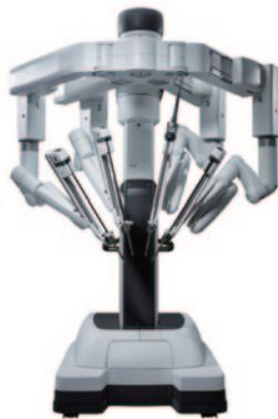
従来より、ロボットアームが細く、動きも繊細かつ複雑になって、精度の高い手術が可能になりました。アームの先端に取り付けた鉗子には関節機能があり、人間の手の可動範囲を越えて曲げたり、回転させることも可能です。また、これまでは内視鏡カメラは4本のアームのうち、1本にしか取り付けできませんでしたが、4本すべてのアームに可能になり、視野が広がりました。
