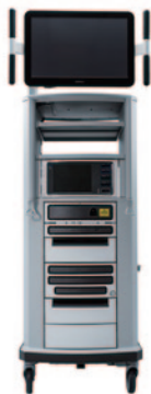
「ダヴィンチXi」の心臓部となるコンピュータ・システム。手術部位の3D画像を作り出し、ロボットアームの遠隔操作もこのコンピュータを通して行われます。
