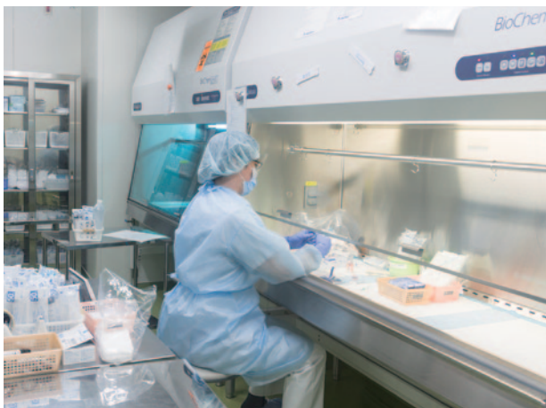
抗がん剤の調製は、すべて無菌室の中の「安全キャビネット」を使用して行われています。基準的な清浄環境の中で、塵埃や微生物が点滴薬に入らないように調製。また、病院の空气中に抗がん剤が漏れ出すことも防止します。
