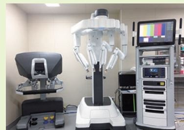
前立腺などの摘出に用いられる手術用ロボット「ダ・ヴィンチ」。医師がモニターを見ながら、ロボットのアームを遠隔操作する
